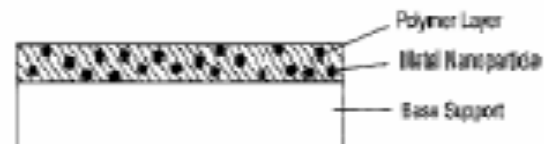
(D) Metal Nanoparticle-Embedded Polymer Coating
